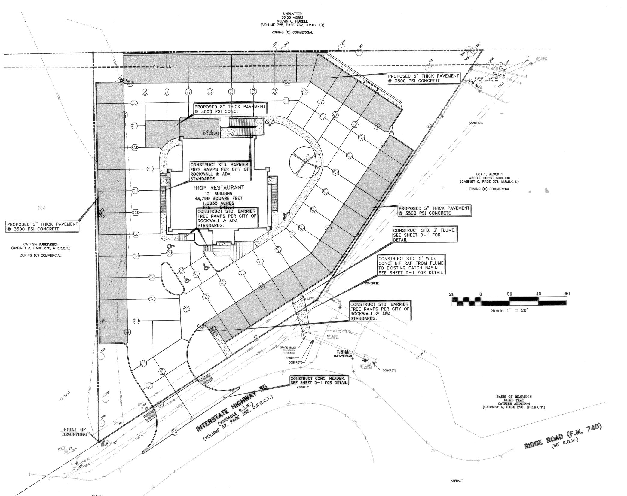
JOINT CONTROL & PAVING PLAN
