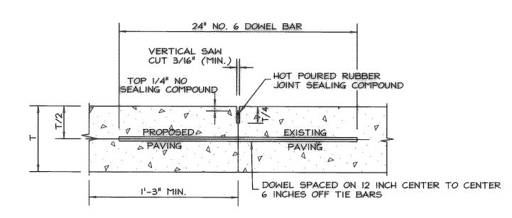
LONGITUDINAL BUTT JOINT
