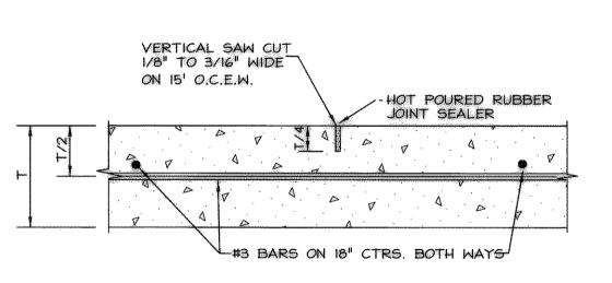
SAWED DUMMY JOINT DETAIL
