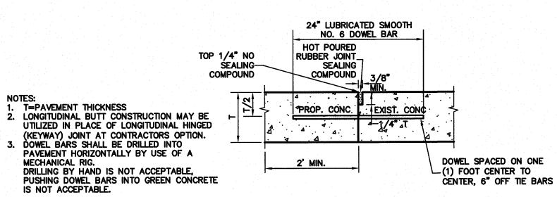
LONGITUDINAL **BUTT JOINT** NOT TO SCALE
