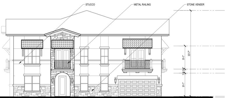
2 BLDG TYPE III - RIGHT ELEVATION
