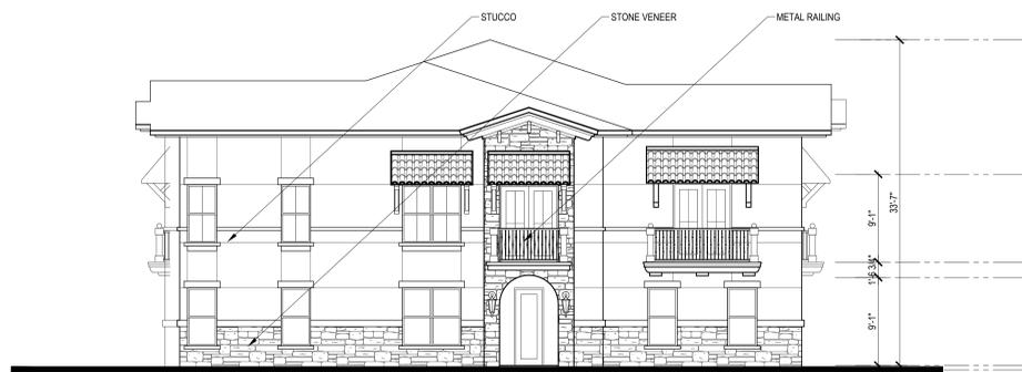
2 BLDG TYPE II - SIDE ELEVATION
